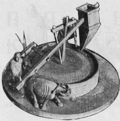
Приспособления для размалывания зерна, попросту говоря,—мельница, она приводится в движение быком
